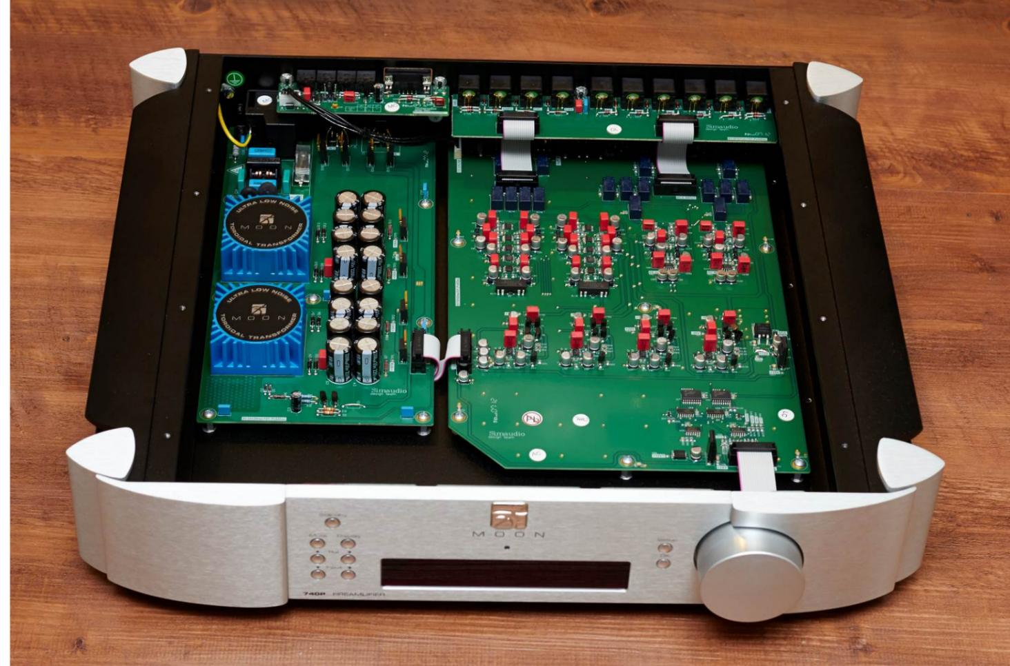
術最早見於 1998 年 Moon W-5 後級，又稱為 Zero Global Feedback，透過對訊號修正需求之減少，擴大機的速度較傳統迴授設計增加許多，聲音品質也隨之改善。傳統擴大機的回授線路從擴大機的輸出級(output stage)負迴授到增益級(gainstage)，以減少總諧波失真(THD)，越多的迴授所減少的 THD 就越多，然而整體無迴授的好處為及時的放大、更正確無音染的聲音、沒有內部線路的失真、減少相位差、喇叭也無法影響擴大機的運作、動態範圍亦隨之增加。原廠宣稱可以讓重播的結果更富音樂性，獲得更平衡的音色。打開機箱映入眼簾的大型環狀變壓器也是
