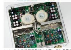
C-02：箱內的雙層電路板（上下二層）採用大量發熱管零件組成全平衡前級擴大機
