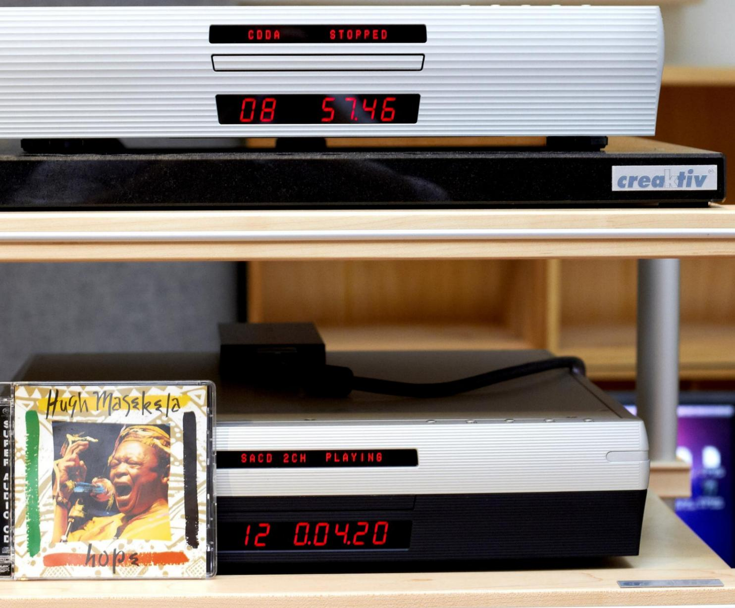
Andreas 也將其用在 DSD 的長才用在 Playback Designs 上，所有的訊號在進入類比時，都先升頻到 DSD 5.6MHz 的規格(SACD 的 2 倍)，是 CD 44.1kHz 的 128 倍。Playback Designs 將其獨家的 DAC 技術稱之為 PDFAS (Playback Designs Frequency Arrival System)，是由 Andreas 所研發的，其不使用傳統的相位鎖定迴路 PLLs,( Phase Locked Loops)來控制或將 jitter 減至最低，PDFAS 是將 jitter 的問題完全移除。
