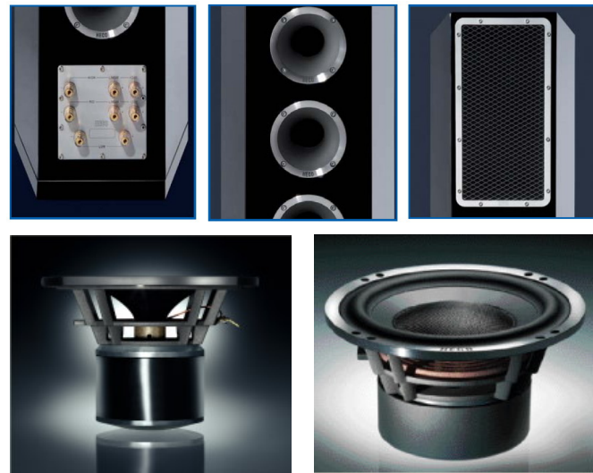
左圖：Statement 的高、中、音單體各自具有特殊的設計 右上：第 1 張圖為喇叭端子圖，可看出是 3 路分音設計，其中中高音還各自有 2dB 的跳線可選擇，在使用上留了相當的彈性空間，中間的圖為反射孔，有著精密的用料，最右邊的圖則是 statement 很大的特色，中音單體音室的保護罩。 右下：可看出中低音單體有著非常大的鋁鎳鈷磁鐵系統，可提供單體非常強而有力的控制。
