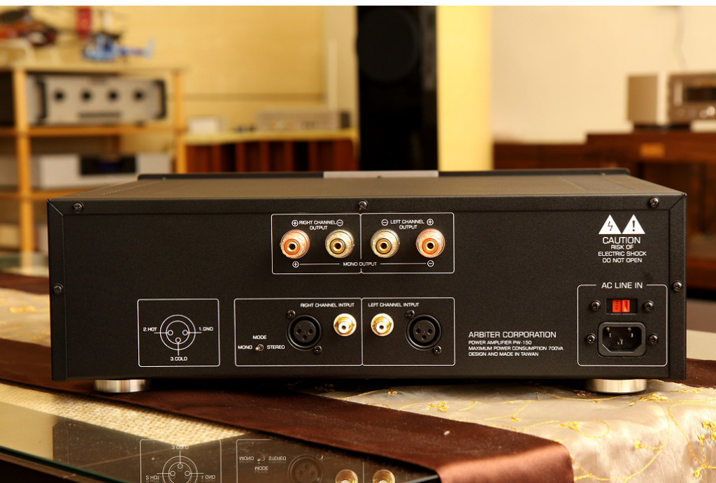
背板配置，簡潔明瞭，訊號輸出入端子，共有 1 組平衡、1 組 RCA，電源輸入座為標準 IEC，上面也可看到 Made in Taiwan
