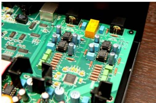
本機的 DAC 晶片使用了 AKM 出產的 AK4399，這顆曾經出現在 Marantz、Cary 廠機的解碼晶片，具有最高 216KHz/32Bits 的解碼能力，以及高達 123dB 的動態範圍，真是非常強悍的規格，AKM 的解碼晶片這幾年在 Hi-End 市場快速竄起，可見得實力不容小覷。在 DAC 之後的低通濾波器(Low Pass Filter, LPF)以及緩衝器(Buffer)，本機每聲道使用了二顆 BB OPA134 運算放大器，從電路結構上看來應為直接交連，聲音路徑上少了電容器交連，這種做法可以呈現出更直接的音色與無限制的低頻動態，設計者更在每顆 OP 旁都用上了 Philips 發燒電容做為小水塘，類比端電阻更全數用上了價格不斐的 Dale 精密電阻，給聲音的醇厚更添增了一份保障。
