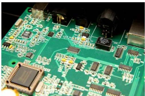
本機數位接收部分使用了 CIRRUS LOGIC 生產的 CS8416，擁有最高 192KHz 的數位接收能力，並且內建多功器可以切換接收不同的訊號源，甚至具有重整訊號時脈的功能，一般也常把這樣的功能稱做一種 De-Jitter，降低時基誤差，讓音色毛邊更少，背景更沉，音相更凝聚，但本機似乎捨棄了這部分功能，或許設計者有其他的考量。輸入端平衡部分使用了脈衝隔離變壓器做訊號轉換與隔離，但在 SPDIF 同軸輸入的地方卻只用了電容做簡單的訊號交連，設計上或許還是有些成本考量吧！
