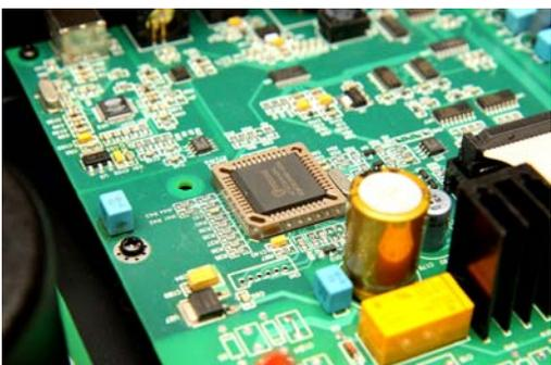
Lotus DAC1 還使用了一顆單晶片處理器來整合控制，協調面板顯示、按鍵控制、電源啟動與關機程序、解碼晶片設置等，頗有高階 DAC 的氣勢。电路板的佈局也仔細的將各區塊接地鋪銅詳細的規劃，避免了雜訊互串，從這些微小的細節來看應該會具有不錯的訊噪比表現才是。
