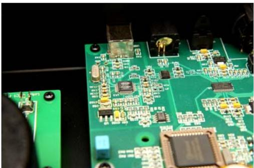
USB 介面也是本機的另一個驚喜，因為個人電腦的方便性，USB 輸入已成為時下最流行的數位類比轉換介面之一，Lotus DAC1 也不落人後的跟上潮流，在這部分使用了 TE7022 晶片，具有 96K/24BITS 的接收能力，LotusDAC1 在 USB 接收部分使用了由 PC 端供應的 5V 電源，經過接收轉換後，再透過 TI 的訊號隔離 IC 來傳遞資料給後端 DAC，這樣的有效的將 USB 可能帶來的雜訊完全隔離，避免了 DAC 本身受到了 USB 雜訊干擾，影響了音質表現，這真的是相當聰明且講究的做法，類似的做法也出現在 Arye QB-9 身上，顯示了本機追求 Hi-End 表現的不妥協。
