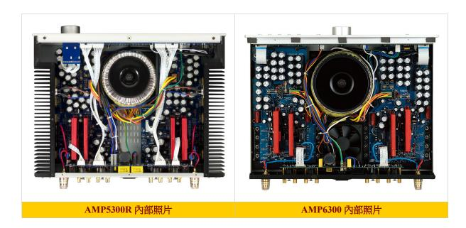
從上圖來看, AMP5300R 與 AMP6300 差異最多的, 莫過於變壓器的大小與前級線路兩 大部分。從規格與照片比照來看,AMP6300 內部使用  $100000 \, \mu \, \text{F}$  的電容, $600 \, \text{W}$  的 toroidal 環型變壓器,16 個 15A 的大型功率電晶體,而 AMP5300R 所使用的變壓器則 就沒有 AMP6300 那麼大了。此外,AMP5300R 的前級部分只作單純線路輸入選擇之用, 並沒有對信號進行任何的放大,這點與 AMP6300 可針對不同訊源做增益調整的做法更 是大異其趣。而音量調節部分則與 AMP6300 相同,採用 DIGM (Digital Intelligent Gain Management)智慧增益管理電路調整增益,可使音量控制範圍和精度得到進一步提升。
