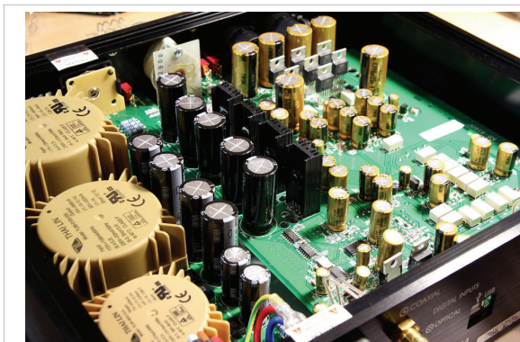
多組獨立電源與多級穩壓電路
