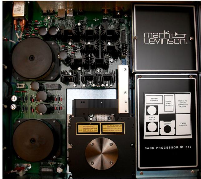
右上角則是數位類比轉換模組，這邊 ML 使用一個金屬的黑盒子蓋起來並不是為了保密，而是爲了要將類比輸出與數位輸出進行隔離，這個模組使用 6 層的 PCB 板，其材質爲高檔具有高速傳輸特性，由 Park 公司所生產的『Nelco N4000-13 SI』，爲了減少時基誤差(jitter)，在轉盤讀取數位資料後，會先送到緩衝記憶體暫存，DDS 線路(Direct
