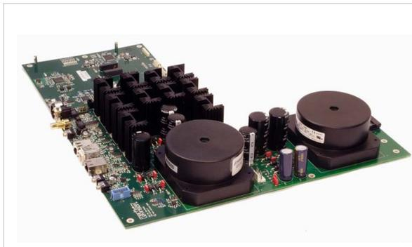
主電路板，包括兩顆獨立的環型變壓器、數位輸出線路及控制線路
