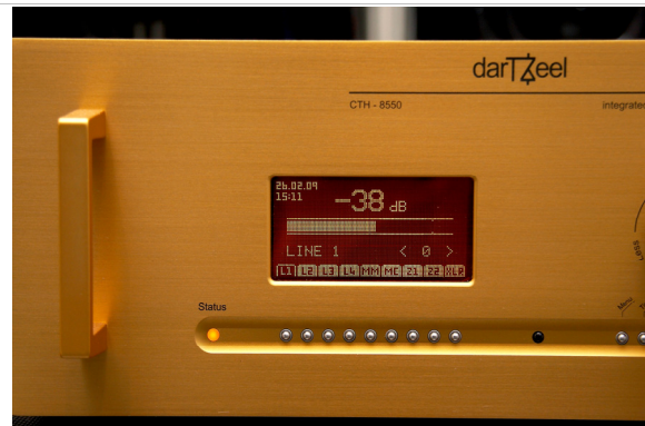
大型的顯示螢幕讓用家可以一目瞭然，下方的小按鈕則對應著各個的來源切換
