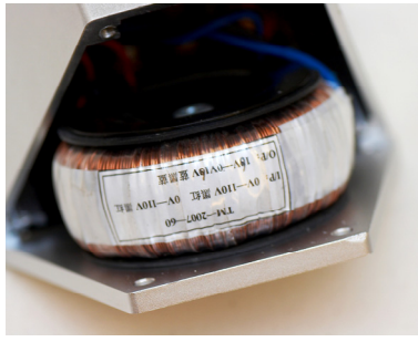
位於底部的大型環型變壓器
