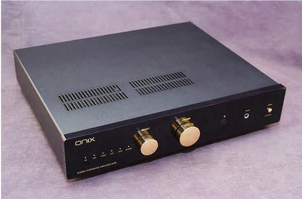
輸入靈敏度：205mV/47K 歐母、最大輸出功率：66W/8 歐母、頻率響應：10Hz-30KHz(-0.5dB)、聲道分離度：>51dB 總諧波失真：<0.003% (3W/8 歐母)、信噪比：>91dB(A 計權)、消耗功率：<200W、工作溫度：0-40 度 C、體積(寬 x 深 x 高)：430x401x109 mm、淨重：約 10.5Kg、定價：NTD 42,000、藝聲(代理)：[www.soundart.com.tw](http://www.soundart.com.tw)
