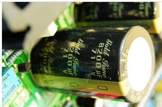
經過反覆試驗而採用的電解電容
