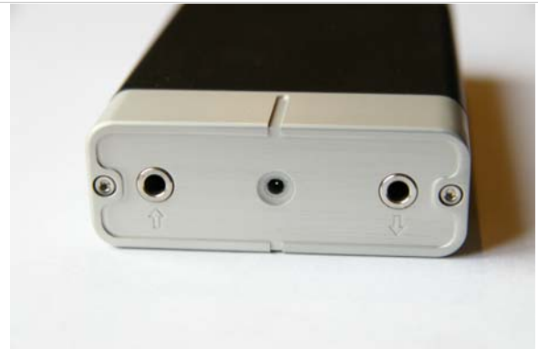
背後面版，由左到右依序為 輸入接孔、DC 充電接座、輸出接孔
