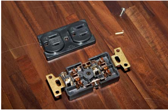
oyaide MTS-6 的插座由原本普通版的改爲鍍金鍍鈹的 SWO-XXX，內部配線也已全部更換爲 oyaide EE/F-S 2.6
