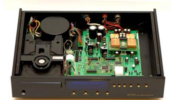
放大模組上有 Onix 的標記，共有 2 對 4 組，平衡設計之用，內部線路與機殼做了接地的連接。
