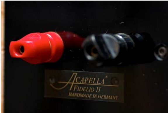
所有喇叭均採用 single-wire 的接線方式
