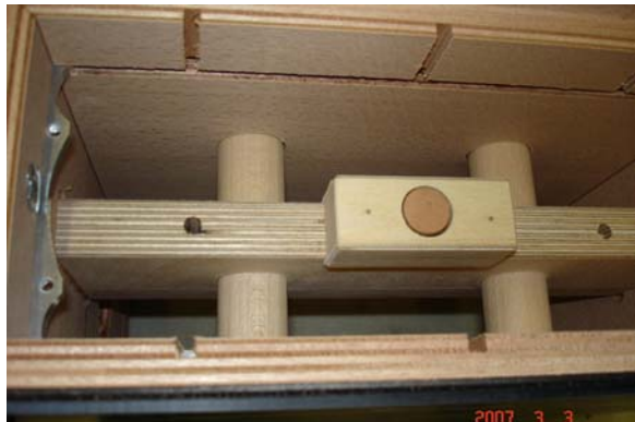
箱體的內部結構非常堅固，在螺絲的鎖點上使用了內嵌的金屬片加以固定。
