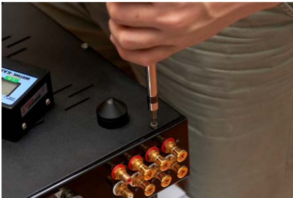
使用扭力起子將每個鎖點固定在同一個值
