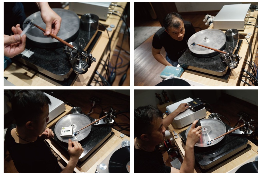
左上：為唱臂添加阻尼油 右上：檢視唱頭的方位角 (Azimuth) 左下：針壓的調校，約在 2.2g 左右上下 右下：轉速的調整
