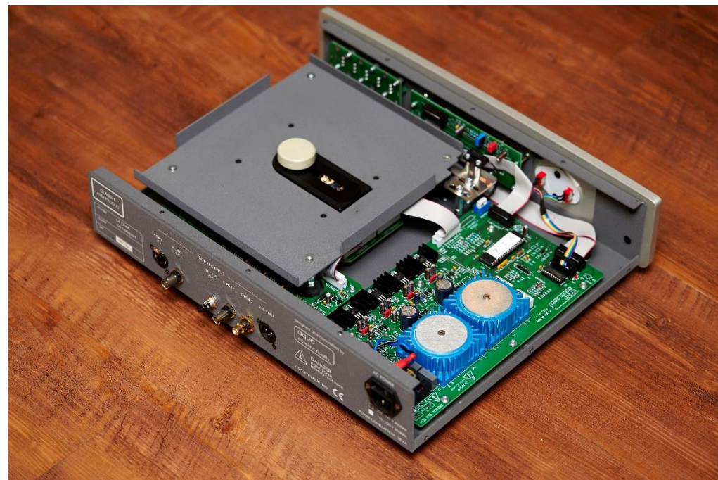
La Diva 的內部，一樣使用雙獨立變壓器，一個給轉盤讀取用，一個給數位線路用，強化改良後的 Philips CD-Pro2 雷射讀取系統，原廠還設計了良好的避震架構，在讀取時非常安靜穩定。
