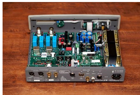
左 1, 右 1：La Scala MKII，外型典雅耐看，使用相當特殊的陶瓷纖維(Nextel) 左 2, 右 2：La Diva，上蓋讀取式的轉盤，雙機殼設計非常堅固，轉盤使用反應極快 左 3, 右 3：La Scala MKII 的內部，採用雙獨立變壓器，前方類比輸出有兩隻 ECC81 真空管
