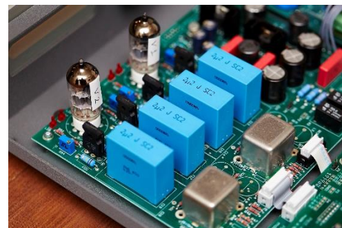
左 1, 右 1：La Scala MKII，外型典雅耐看，使用相當特殊的陶瓷纖維(Nextel) 左 2, 右 2：La Diva，上蓋讀取式的轉盤，雙機殼設計非常堅固，轉盤使用反應極快 左 3, 右 3：La Scala MKII 的內部，採用雙獨立變壓器，前方類比輸出有兩隻 ECC81 真空管
