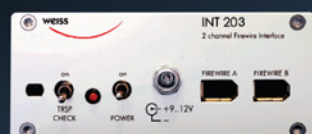
Firewire D/D Interface INT203/INT202 電腦數碼音頻界面
