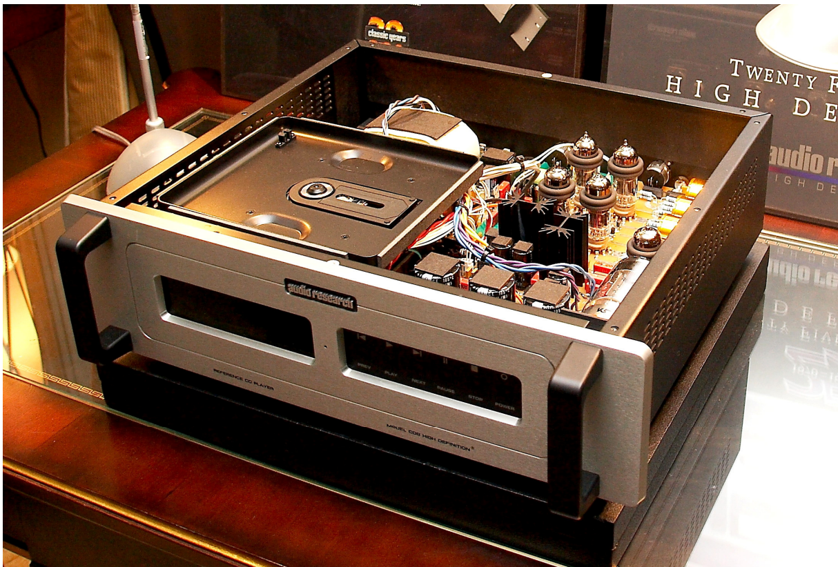
這張內部圖是我在 2009 CES 上拍的，可看到右下方輪的是一支 6550C 真空管
