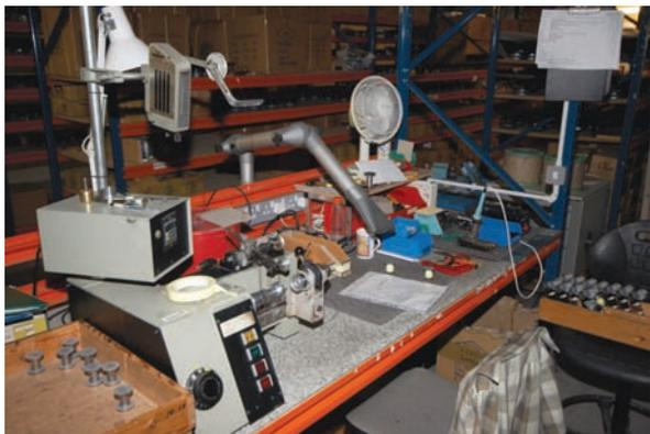
在瞭解了單體的製作過程後，再來就是分音器的部份了，2007年Spendor在分音器的部份有很大的精進，包括使用更好的元件、更好的設計。這邊可以看到繞製線圈(coil)的機器，用來做分音器的電感(inductors)。
